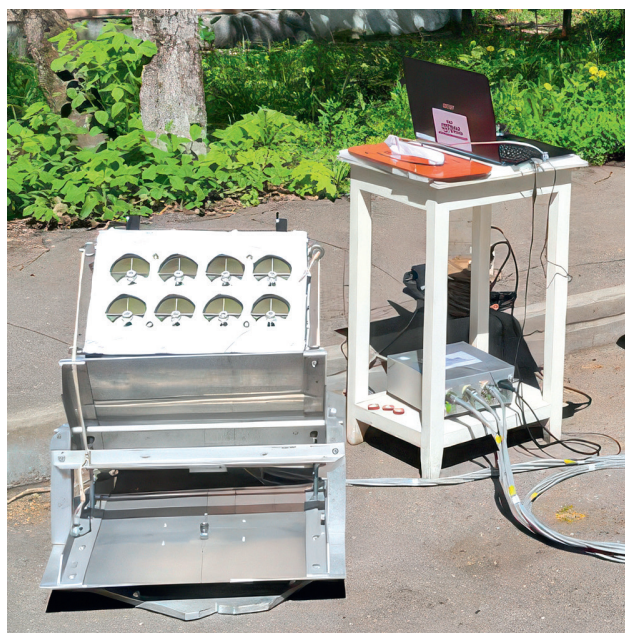
Рис. 1. Научная аппаратура эксперимента “Солнце-Терагерц” в процессе измерения солнечного излучения.
