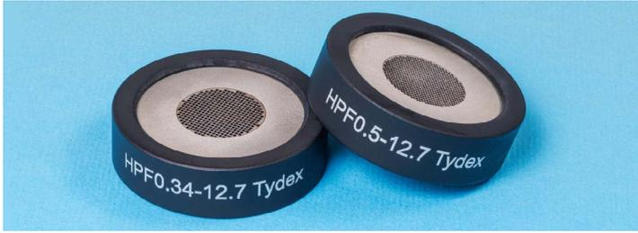
ТГц фильтры высоких частот предназначены для блокирования низких частот и пропускания высоких частот терагерцового диапазона. Фильтры представляют собой металлические пластины со сквозными отверстиями субволновой размерности. Пластины устанавливаются в оправы с прижимным кольцом. По принципу действия они относятся к фильтрам, в которых микроотверстия играют роль волноводов с частотой отсечки, определяемой геометрией отверстий.
