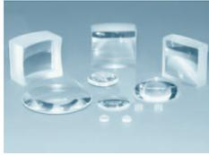
Кварцевое стекло может быть получено разными методами - высокотемпературным плавлением кристаллов натурального кварца, плавлением высококачественного песка, а также в результате плавления не натурального, как в первых двух случаях, а предварительно синтезированного и, т.о., обогащенного кремний-содержащего сырья.
