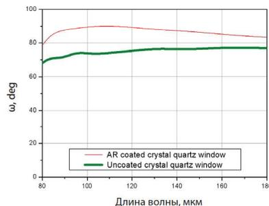
Рис.2.б) Угол  $\omega$  АВП L/4@60-95мкм.
