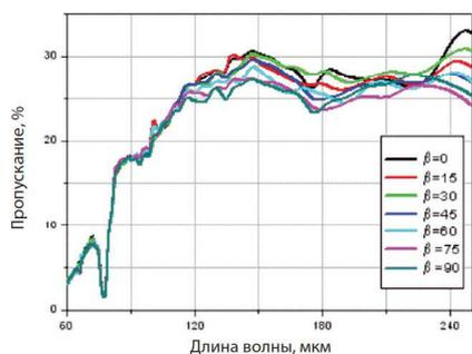
Рис. 4. Измеренные спектры пропускания АПП L/4@60-300 мкм при различных позициях анализатора.
