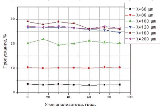
Рис. 5. Измеренное пропускание АПП L/4@60-300 мкм в зависимости от угла поворота анализатора  $\beta$ .
