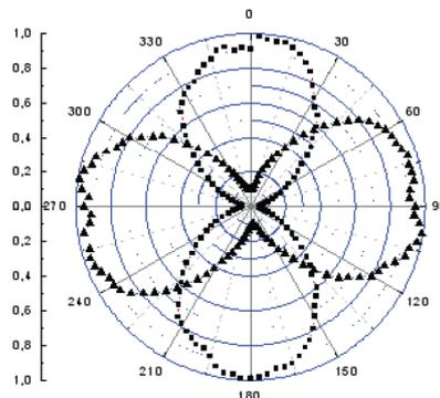
Рис. 6.б) Интенсивность лазерного излучения в зависимости от угла поворота анализатора в случае циркулярно-поляризованного излучения, прошедшего через АВП L/4@60-95 мкм.
