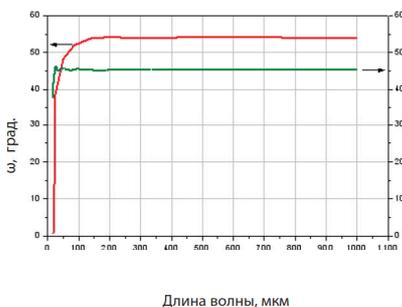
Рис.2.а) Угол  $\omega$  АПП L/4@60-300мкм.
