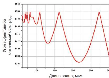
Рис.3.а) Угол эффективной оптической оси АПП L/4@60-300мкм.
