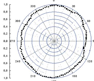
Рис. 6.а) Интенсивность лазерного излучения в зависимости от угла поворота анализатора в случае линейно-поляризованного излучения, прошедшего через АВП L/4@60-95 мкм.
