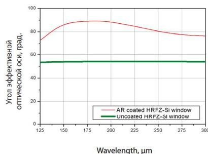
Рис.3.б) Угол эффективной оптической оси АВП L/4@60-95мкм.
