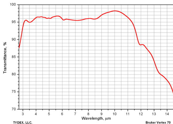
Рис. 2.3. Просветление на 3-5 и 8-12 мкм на германии.
