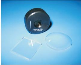
Кристаллический кварц является анизотропным одноосным кристаллом с тригональной структурой. Кристаллическая структура имеет каркасный тип и построена из кремнекислородных тетраэдров, расположенных винтообразно (с правым или левым ходом винта) по отношению к главной оси кристалла.
