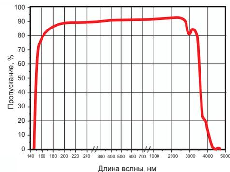
Рис. 1 Пропускание кристаллического кварца в УФ-, видимой- и ИК-области. Толщина образца 8.6мм.
