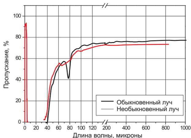
Рис. 2 Пропускание кристаллического кварца в ТГц диапазоне. Толщина образца 1 мм.
