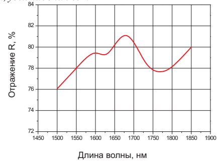
Рис. III-2-2 Светоделительное покрытие R=(80\pm4)\% на 1500-1800 нм, угол падения 0^\circ .
