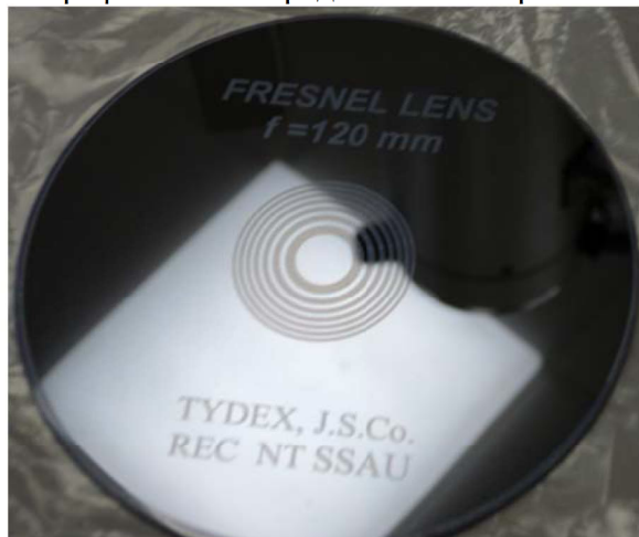
Рис. 1. Фотография бинарной линзы Френеля
